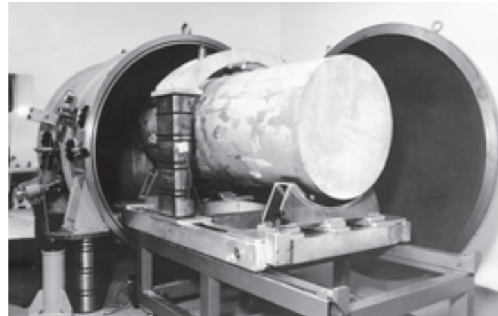
Auch nach Gravitationswellen jagten die Forscher am Münchner Max-Planck-Institut für Physik – Heinz Billing spürte ihnen mit einem Aluminiumzylinder, dem Herzstück des Weber-Experiments, nach.
