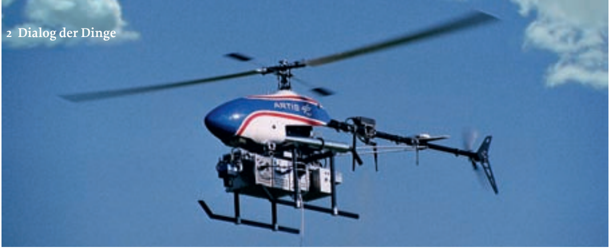
Ein Flugroboter des DLR untersucht experimentell Algorithmen für autonome intelligente Funktionen.
