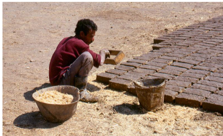
Abb. 1: Lehmziegel sind eine Innovation aus dem Neolithikum – mit Auswirkungen bis in die Gegenwart. Abgebildet ist Lehmziegelherstellung im heutigen Ägypten [aus 2, S. 73].
