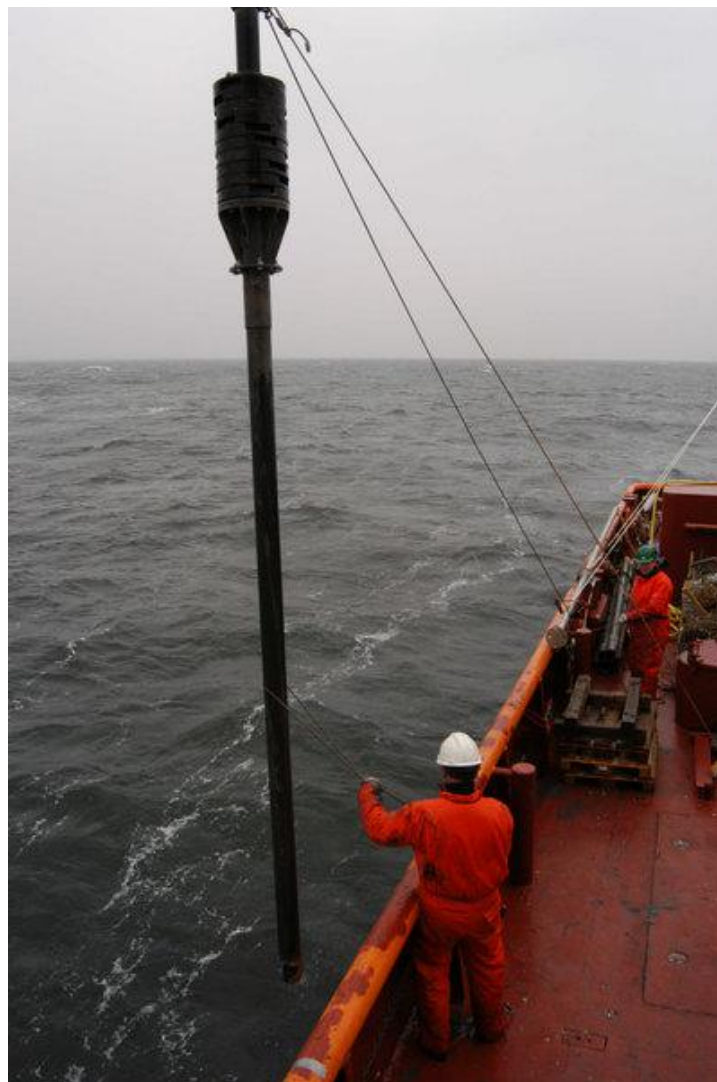
Feldarbeit in der Nordsee mit dem Dänischen Forschungsschiff RV Gunnar Thorson. Mit einem Schwerelot werden 5 m lange Kerne aus dem Meeresboden gezogen. In solchen ungestörten Sedimentkernen wird die geochemische Zonierung analysiert und die mikrobiellen Prozesse experimentell untersucht. © Bo Barker Jørgensen
