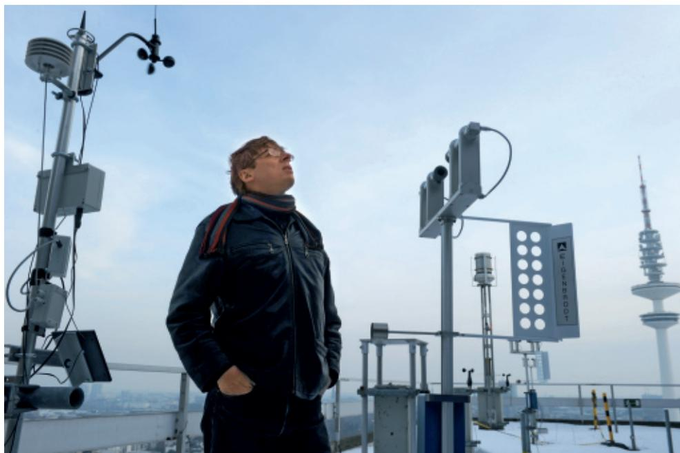
Was zieht denn da auf? Bjorn Stevens auf einem Balkon des Geomatikums der Hamburger Uni. Im rechten Bildteil ein Lasergerät, das die Niederschlagsintensität misst.
