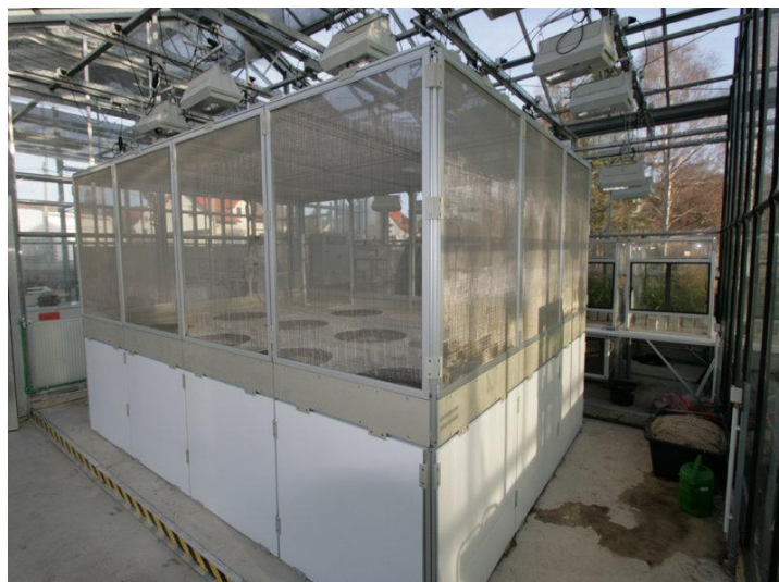
Abb 1: Experimenteller Mesokosmos im Gewächshaus des Instituts. Die Anlage besteht aus zwölf Zylindern, die jeweils für Populationen von bis zu fünf Pflanzen geeignet sind. Jeder Zylinder enthält eine 1 Meter tiefe Erdmischung, die dem Erdprofil im natürlichen Lebensraum der Tabakpflanzen entspricht. Die Zylinder werden automatisch bewässert. Der überirdische Teil des Mesokosmos ist mit einem Stahlnetz umschlossen, damit Licht und Gase ausgetauscht werden und sich die Insekten innerhalb des Systems frei bewegen können.
