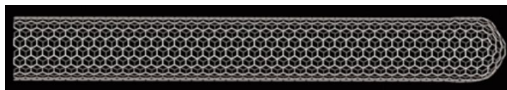
Computermodell einer Kohlenstoff-Nanoröhre. © Max-Planck-Institut für Festkörperforschung
