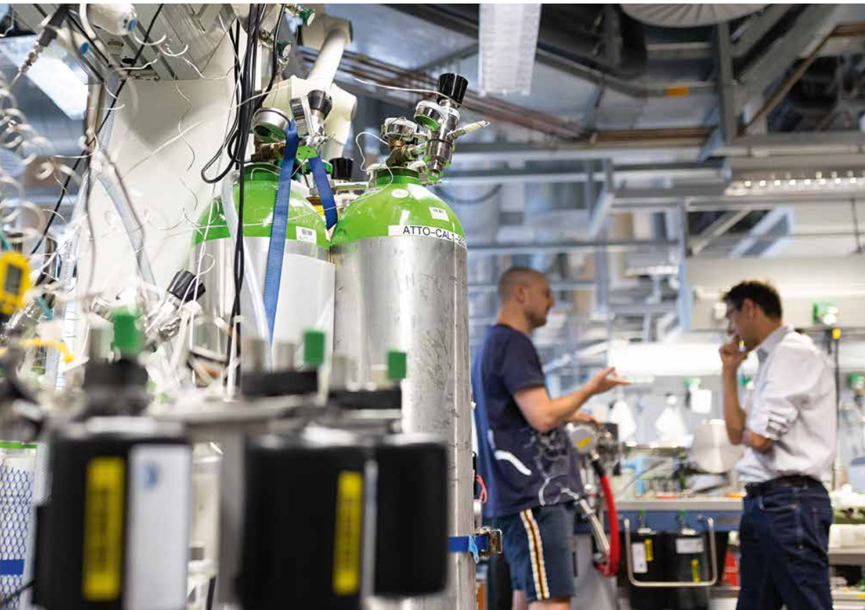
Treibhausgasen auf der Spur: Heiko Moossen (links) und Sönke Zaehle erforschen die Zu- und Abnahme von Lachgas, aber auch Kohlendioxid und Methan in der Atmosphäre und analysieren zu diesem Zweck mit Massenspektrometern deren Isotopenverhältnis. Dabei dienen ihnen die reinen Substanzen aus Gasflaschen als Referenz.
