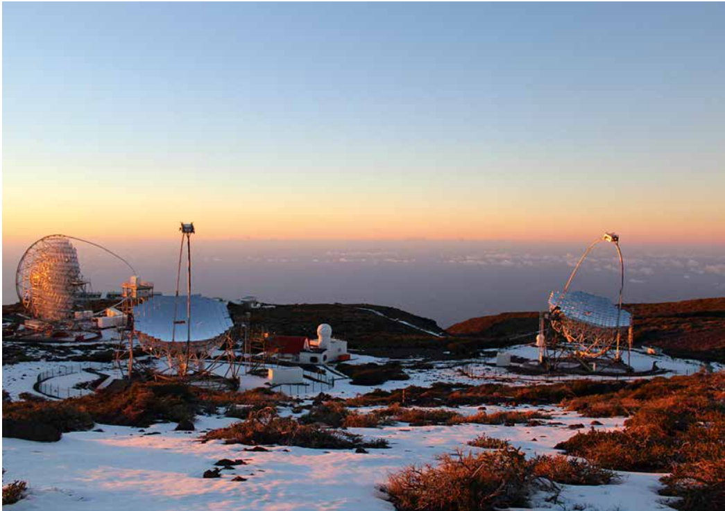
Augen fürs All: Die beiden Magic-Teleskope auf dem Roque de los Muchachos registrieren Teilchenschauer in der Erdatmosphäre und beobachten damit indirekt Gammastrahlung aus den Tiefen des Universums.
