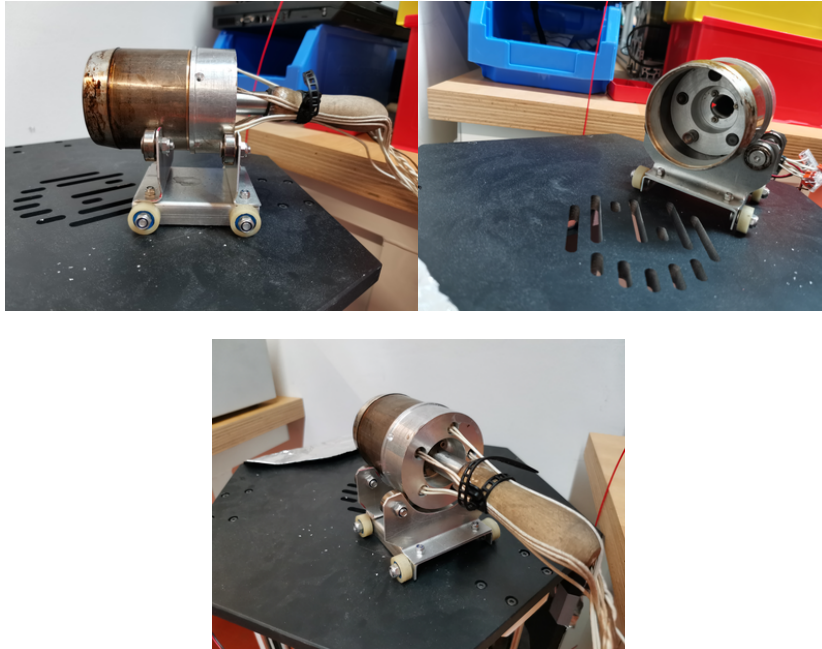
Abbildung 11: Verteiler-Schweißgerät (Spezialwerkzeug selbstgefertigt)
