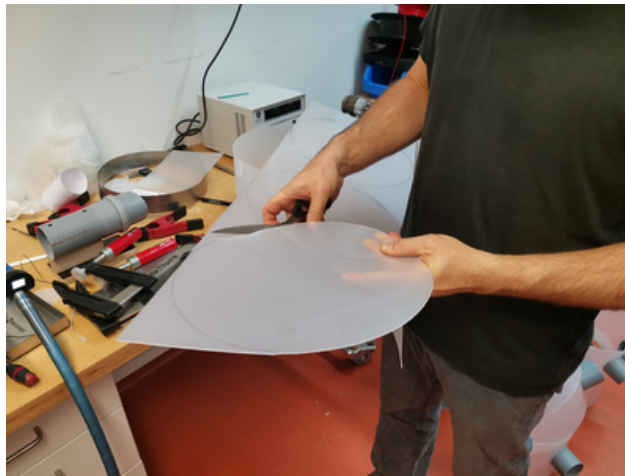
Abbildung 15: Scheibe als Abschluss ausschneiden und später anschweißen
