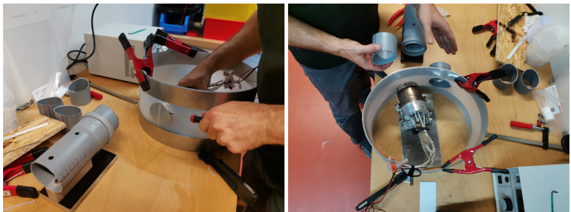
Abbildung 14: Loch schmelzen und Flansch anschweißen
