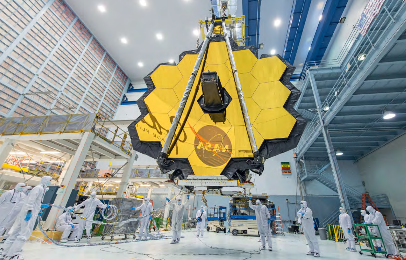
Gigantisches Facettenauge: Der goldbedampfte Hauptspiegel des James Webb Space Telescope hat einen Durchmesser von sechseinhalb Metern und besteht aus 18 Segmenten. Frühestens von Mai 2020 an soll das Instrument den Himmel durchmustern und auch ferne Exoplaneten ins Visier nehmen.
