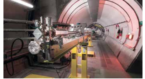
14 Kernstück des AWAKE-Experiments: die zehn Meter lange Plasmazelle
