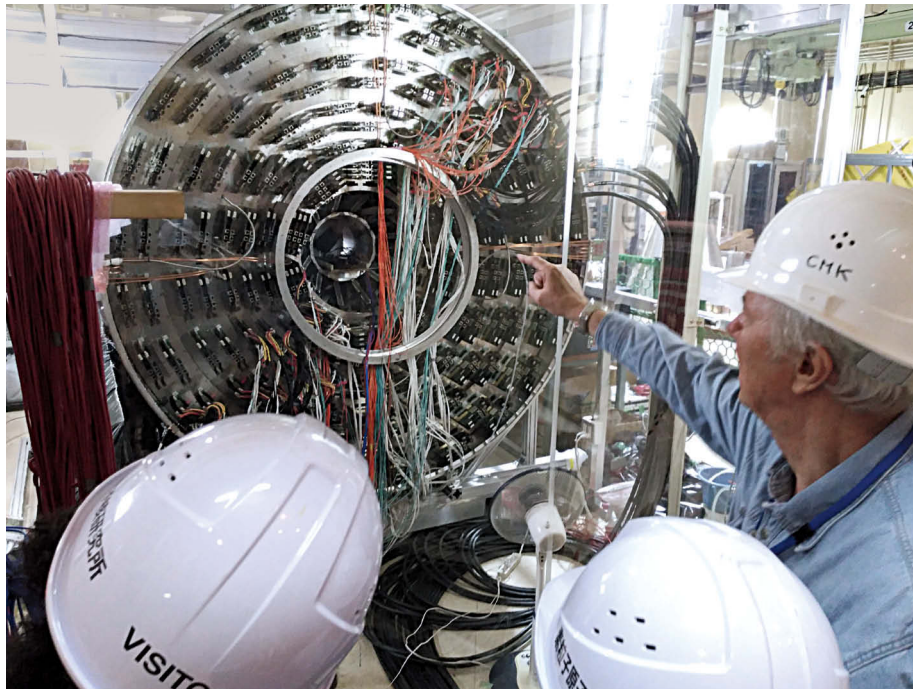
Christian Kiesling (rechts) und seine Kollegen begutachten die Fortschritte beim Aufbau des Belle-II-Detektors am SuperKEKB. Kiesling deutet auf die Öffnung, die den Vertexdetektor aufnimmt, mit dem der genaue Ort des Zerfalls bestimmt wird. Den Kern dieses Instruments bildet der zweilagige Pixeldetektor (links oben), in dessen Innerem die Zerfälle stattfinden. Er setzt sich aus Modulen zusammen, deren Bildsensoren jeweils 200 000 Pixel umfassen (links unten).
