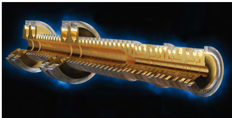
Mit einer Penning-Falle fangen Forscher um Klaus Blaum geladene Teilchen wie Protonen und Antiprotonen. Ringförmige Elektroden erzeugen die elektrischen Felder, um die Ionen festzuhalten.
