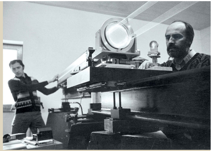
Neue Technik: Kernstück der zweiten Generation von Detektoren sind Laser. Hier arbeiten Walter Winkler (links im Hintergrund) und Karl Mäischberger im Jahr 1977 am Prototyp eines solchen Interferometers.
