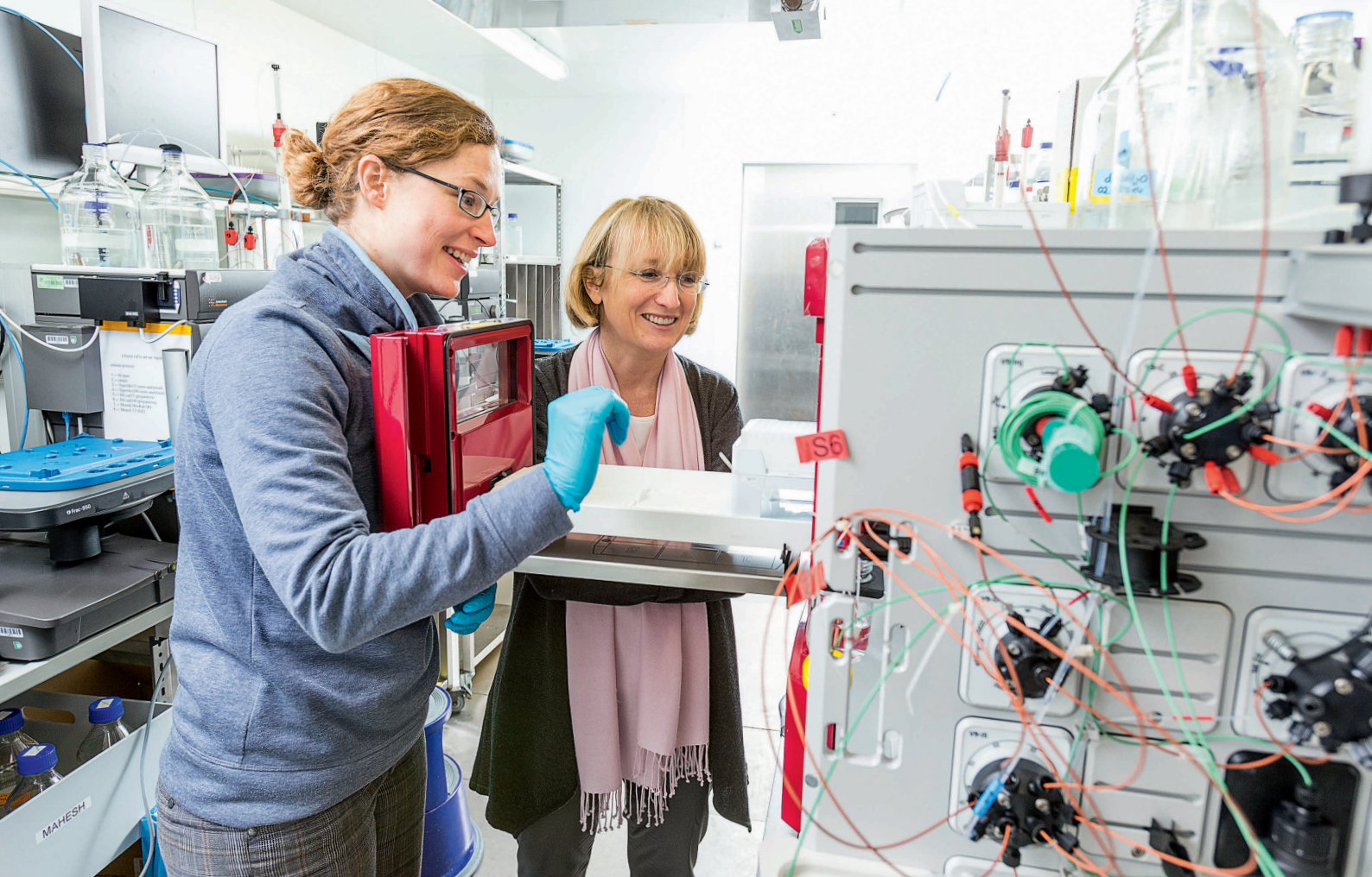
„Das ist der aufregende Teil des Tages“: Ihren täglichen Rundgang durchs Labor möchte Elena Conti nicht missen. Hier stehen sie und ihre Mitarbeiterin Eva Kowalinski (links) am Chromatografiegerät, das der Reinigung von Proteinen dient.
