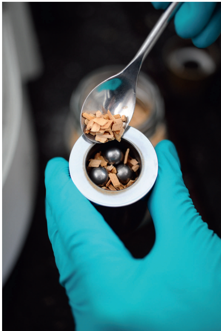
Eine einfache Route zum Zucker: Eine Kugelmühle zerreibt Holzspäne mit Schwefelsäure. Auf diese Weise lässt sich Cellulose auch ohne eine teure ionische Flüssigkeit spalten. Es entstehen Oligosaccharide, die leicht weiterzuverarbeiten sind.
