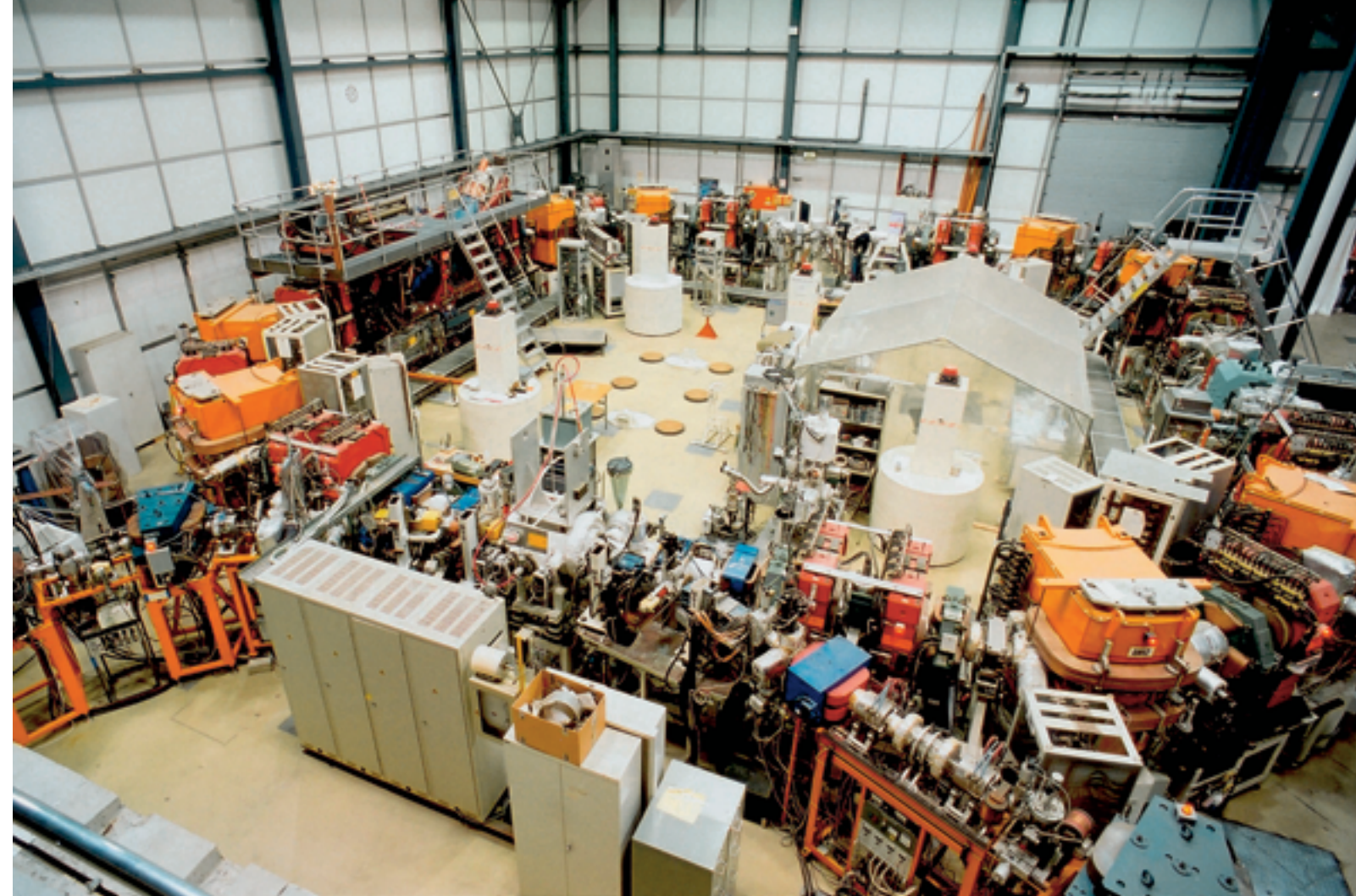
„Rennbahn“ für Teilchen: Im Heidelberger Testspeicherring laufen Lithium-Ionen mit einer Geschwindigkeit von 19 000 Kilometer pro Sekunde. Forscher messen damit den Effekt der Zeitdilatation.
