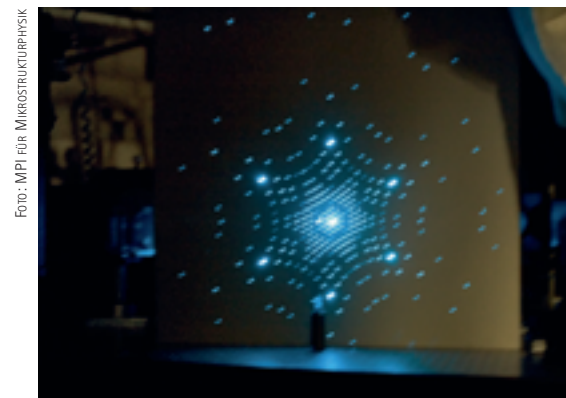
Aus den Nanostrukturen stellen die Wissenschaftler auch photonische Kristalle her, die einen Laserstrahl zu einem regelmäßigen Muster aufblühen lassen.
