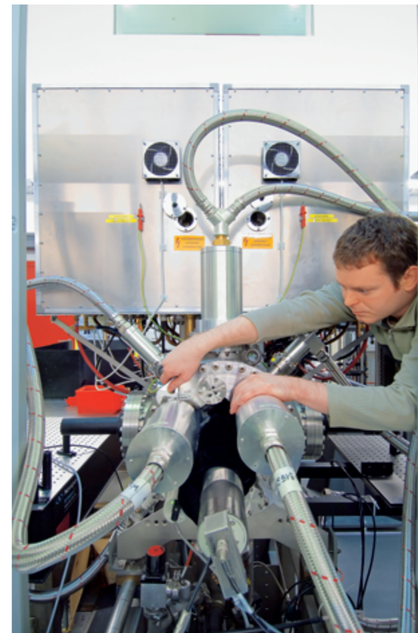
Hightech im edlen Design: Der Berliner Stark-Verzögerer (gegenüberliegende Seite) bremst Moleküle ab. Danach erreichen sie die Falle, an der gerade Bas van de Meerakker schraubt (oben).
