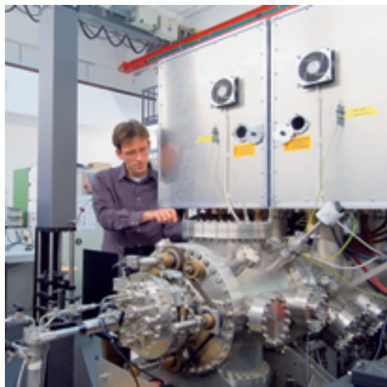
Am Anfangsstück der Vakuummaschine, das den Strahl der OH-Moleküle produziert, hantiert Steven Hoekstra.
