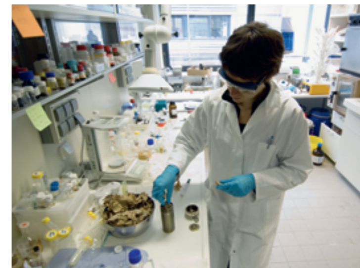
Füllt man Biomasse, zum Beispiel Grünzeug, in ein Druckgefäß (links), gibt ein paar Brösel Katalysator dazu und erhitzt das Ganze unter Luftabschluss auf 180 Grad, erhält man nach zwölf Stunden das schwarze Pulver aus Kohle-Nanokügelchen (rechts).
