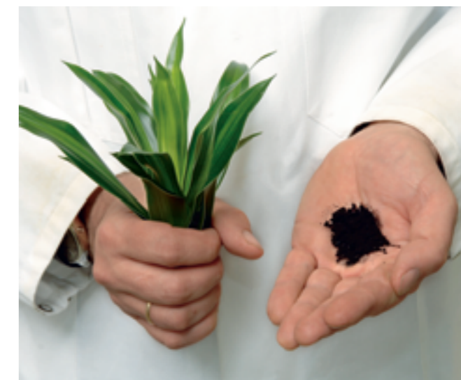
Füllt man Biomasse, zum Beispiel Grünzeug, in ein Druckgefäß (links), gibt ein paar Brösel Katalysator dazu und erhitzt das Ganze unter Luftabschluss auf 180 Grad, erhält man nach zwölf Stunden das schwarze Pulver aus Kohle-Nanokügelchen (rechts).
