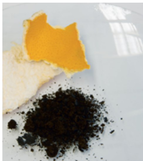
Mittels hydrothormaler Karbonisierung in einem Druckgefäß entsteht aus Biomasse, etwa Orangenschalen, feinstes Kohlepulver (links). Rechts der Erfinder des Verfahrens, Institutsdirektor Markus Antonietti, mit seiner Mitarbeiterin Anna Fischer.
