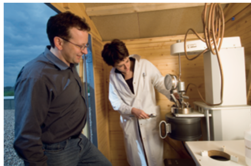
Mittels hydrothormaler Karbonisierung in einem Druckgefäß entsteht aus Biomasse, etwa Orangenschalen, feinstes Kohlepulver (links). Rechts der Erfinder des Verfahrens, Institutsdirektor Markus Antonietti, mit seiner Mitarbeiterin Anna Fischer.
