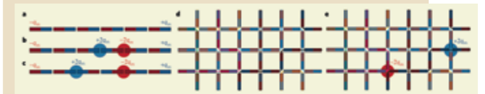
Klappt in einer Kette von Stabmagneten (a) einer um, entstehen bewegliche Monopole (b und c). Im Modell des Spineises laufen die Ketten der Stabmagnete durcheinander (bunte Linien, d). Entlang dieser Ketten bewegen sich die Monopole (e).
