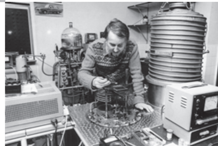
Ohne neue Techniken keine neue Physik: Helmut Lindner präpariert einen Josephson-Kontakt, der auf Radiosignale aus dem All besonders empfindlich reagiert.
