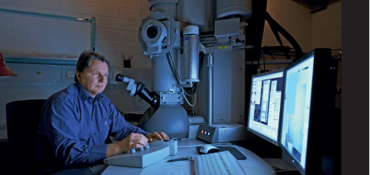
Je kleiner der Gegenstand, desto größer das Mikroskop: Ingo Lieberwirth untersucht Nanoteilchen mit einem mehrere Meter hohen Transmissions-Elektronen-Mikroskop, das eine Probe mit einem Elektronenstrahl durchleuchtet.
