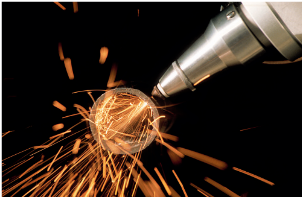
Schneiden mit Licht: Hier durchtrennt ein Kohlendioxid-Laser ein Rohr. Auch zum Schweißen etwa in der Automobilfertigung nutzt die Industrie heute im großen Stil die Hitze des intensiven, gebündelten Lichts.
