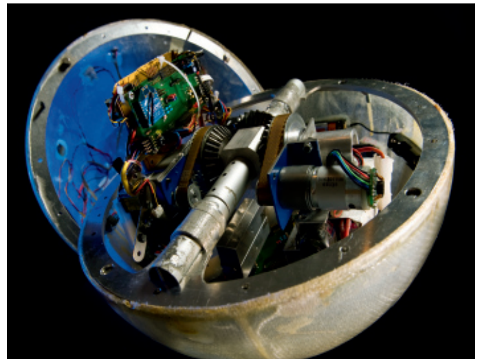
Ein Ball soll rollen lernen: Diesen Kugelroboter hat der Leipziger Künstler Julius Popp entworfen. Elektromotoren verschieben in seinem Inneren Gewichte und stoßen ihn so an. Dank des Gehirns von Ralf Der und Nihat Ay kann er sich in immer komplexere Bewegungsmuster vortasten.
