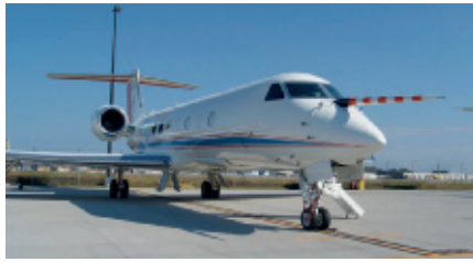
HALO eröffnet den Atmosphärenforschern neue Perspektiven. Auf dem Bild gut zu erkennen ist die Messlanze am Bug.
