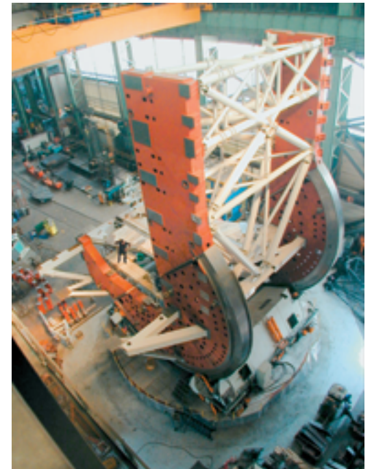
Die 20 Meter hohe Montierung des Fernrohrs.
