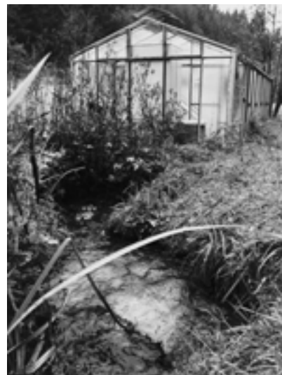
Einem Gewächshaus gleicht die etwa sechs Meter lange Emergenzfalle, die den Breitenbach überspannt.
