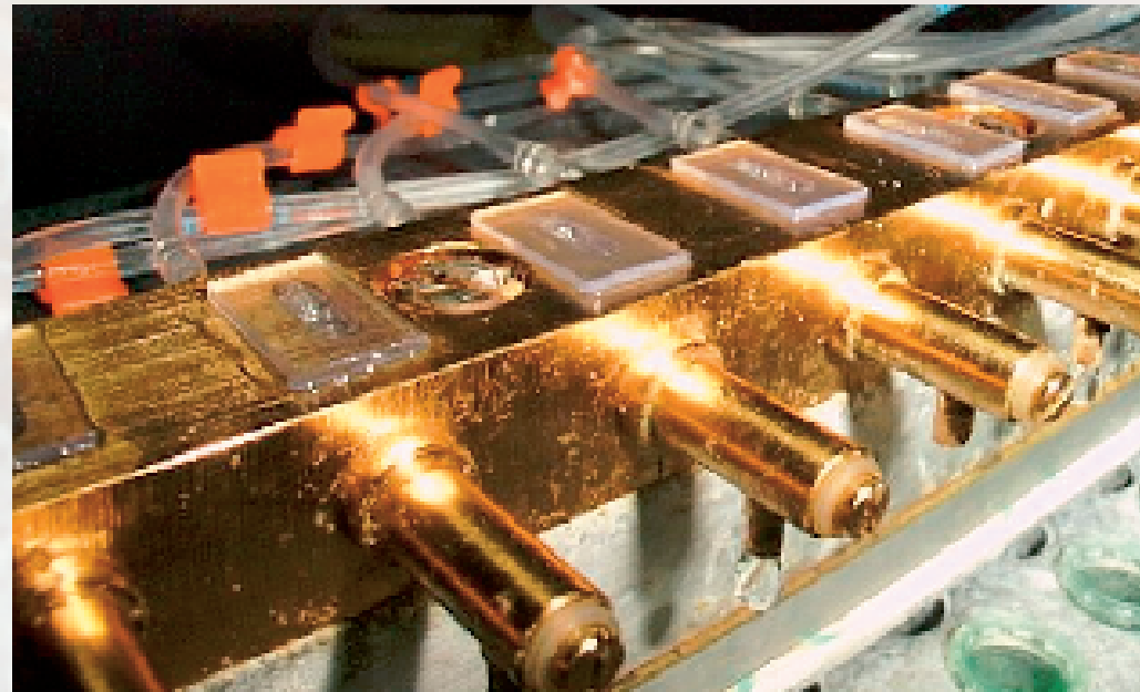
Detailansicht des von Roland Brandstätter an der Forschungsstelle für Ornithologie entwickelten Organkultur-Systems zur Langzeit-Kultur isolierter Zirbeldrüsen. Die Aufnahme zeigt die „Kulturkammern“, in denen sich die Zirbeldrüsen befinden und kontinuierlich mit Kulturmedium umspült werden, das dann in regelmäßigen Abständen gesammelt und auf den Melatonin-Gehalt untersucht wird.
