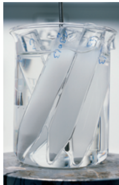
In einem 40 Grad Celsius heißen Wasserbad wird das Apatit-Gelatine-Komposit (weißes Produkt) von der überschüssigen Gelatine getrennt.
