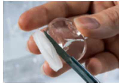
Bänder aus Apatit-Gelatine-Komposit werden aus Gelatine-Pfropfen herausgeschnitten (oben und unten).
