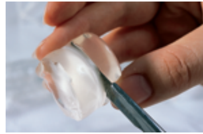
Bänder aus Apatit-Gelatine-Komposit werden aus Gelatine-Pfropfen herausgeschnitten (oben und unten).
