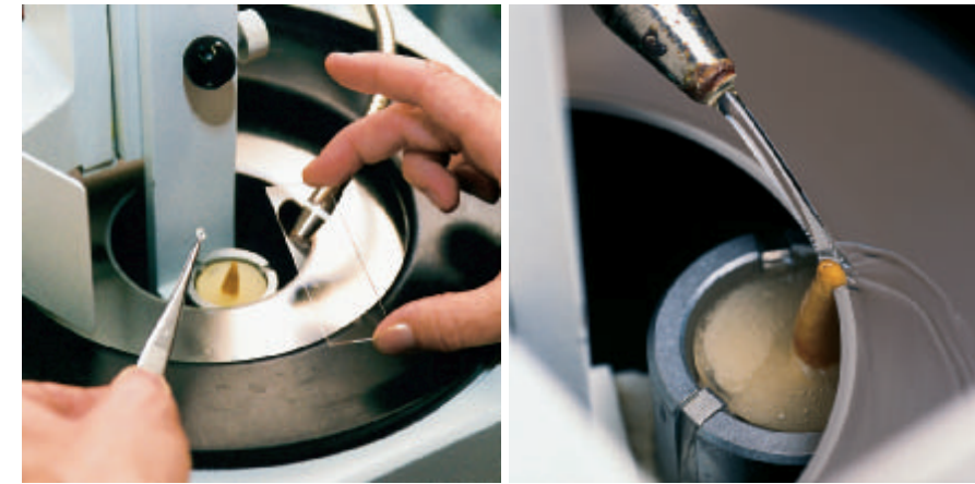
Mit der Präzisionssäge legen die Wissenschaftler einen Querschnitt der Zahnwurzel frei, um die Jahresringe sichtbar zu machen (links). Während des automatischen Schneidvorgangs darf die Reibung nicht zu hoch sein: Wie beim Zahnarzt wird die behandelte Stelle bewässert (rechts).
