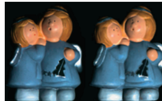
Der Vergleich des Originals (links) mit der Simulation auf dem Computerbildschirm (rechts) zeigt: Von 3D-Scannern erhaltene Daten lassen sich inzwischen so aufbereiten, dass die digitale Repräsentation des realen Objekts einem Foto kaum noch nachsteht – nur dass sich die „virtuellen“ Engel in Echtzeit auf dem Bildschirm drehen und von allen Seiten betrachten lassen.
