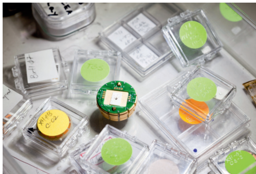
Die Hallenser Forscher bringen ferroelektrische Substanzen für ihre Experimente auf verschiedene Probenträger auf. Der teilweise grün beschichtete goldfarbene Halter in der Bildmitte dient zu Experimenten bei tiefen Temperaturen und in einem Magnetfeld.
