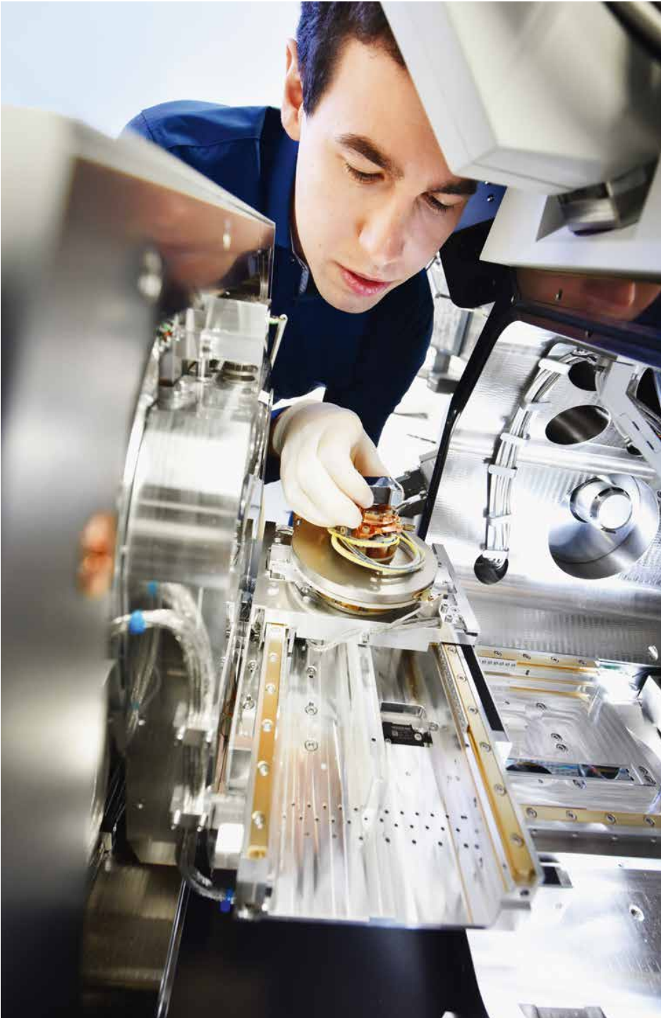
Druckfrisches Metall: Philipp Kürsteiner nimmt die würfelförmige Probe eines Stahls in Augenschein, der aus abwechselnd zähen und harten Schichten besteht. Den Werkstoff hat der Forscher über eine ausgeklügelte Steuerung des 3D-Drucks erzeugt.
