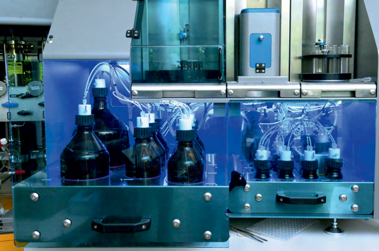
Automatisierte Zuckersynthese: Der Synthesizer bringt die Reaktionspartner zum richtigen Zeitpunkt in der richtigen Menge zusammen. Das Verfahren hat Seeberger in den Firmen Ancora Pharmaceuticals und GlycoUniverse kommerzialisiert.
