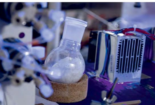
Im Labor entwickelt, für die großtechnische Produktion geeignet: Die aus Pflanzenabfällen gewonnenen Ausgangsstoffe für die Herstellung von Artemisinin (weißes Pulver) müssen nun nicht mehr gereinigt werden, und als Katalysator genügt das pflanzliche Chlorophyll.
