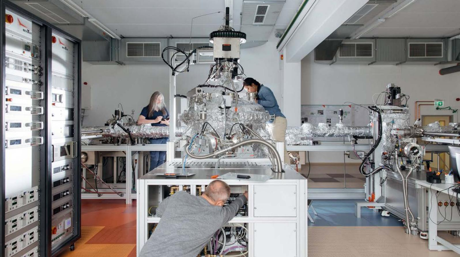
**Oben** Gerhard Fecher, Thomas Krüger und Roshnee Sahoo (von links) erzeugen in der kugelförmigen Sputterkammer zunächst unterschiedliche Materialien, die sie anschließend mit verschiedenen Analysemethoden untersuchen können, indem sie die Proben durch die Röhren der Anlage verschieben.
